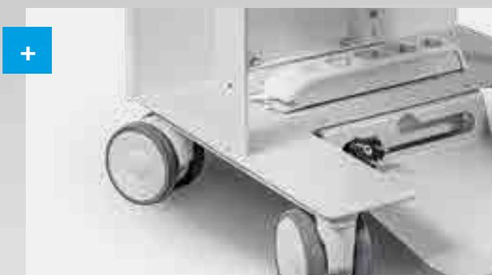
Roues pivotantes, très fluides avec frein de stationnement. Montées sur roulement à billes avec une résistance de charge de 100 kg, grâce à leur grand diamètre (100 mm) elles sont en mesure de surmonter des obstacles tels que, fuites, zones de jonction à différentes hauteurs, petits obstacles.
